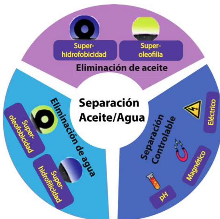
Figura 4.2 Tipos de materiales utilizados en la separación de Agua/Aceite. Adaptada de [126].
