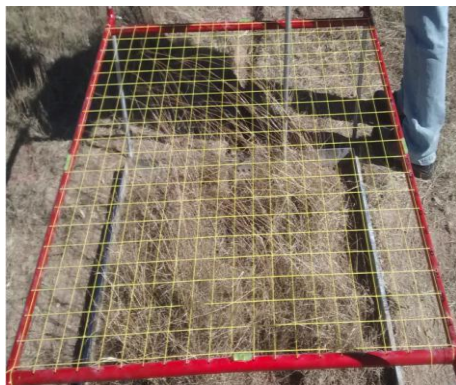
Figura 4. Medición de la microtopografía del suelo en cada parcela con un estadal y un nivel topográfico (Wild-Heerbrugg, 1994); a) mallado de 400 puntos con las tres coordenadas (eje x, eje y, eje z = estadal); b) medición de la microtopografía en campo y caracterización de cobertura en cada parcela.
