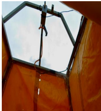
Figura 7. Simulador de lluvia a) colocación de parcelas de escorrentía de 1 m 2 ; b) instalación del simulador de lluvia; c) aspersor de agua, d) tubo se salida de agua de escorrentía y lamina para calibración de la simulación.
