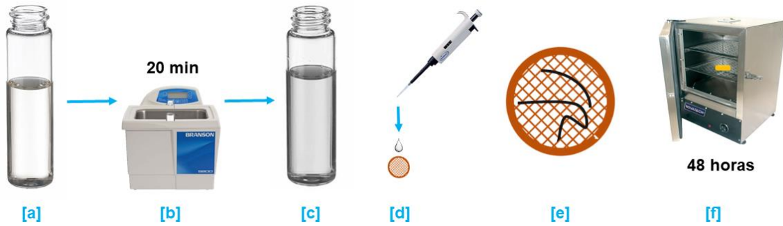
Figura 2.21. Proceso de preparación de muestra para TEM: [a] vial conteniendo etanol previamente lavado mediante el proceso acetona-etanol-isopropanol; [b] se introduce la muestra y se sónica durante 20 min; [c] vial después de sonicarse donde se puede apreciar un tenue cambio en su coloración; [d] representación esquemática de la colocación de dos gotas de la solución sobre la rejilla; [e] esquema de una rejilla de cobre con NTC; [f] se introduce las rejillas a un horno a 67°C por 48 horas.
