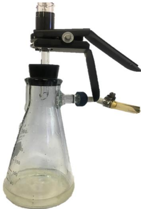
Figura 2.18. Fotografía de proceso de filtración. En este caso se estaba filtrando la solución obtenida de la trampa usada en el método de CVD.
