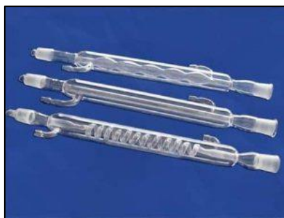
Figura 2.4. Tipos de tubos refrigerantes (TP - Laboratorio Químico © (2018) https://www.tplaboratorioquimico.com )
