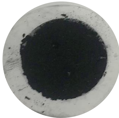
Figura 2.17. Muestra obtenida después de proceso de filtración depositada sobre una membrana de nylon. La parte negra corresponde la muestra S1-34-36.
