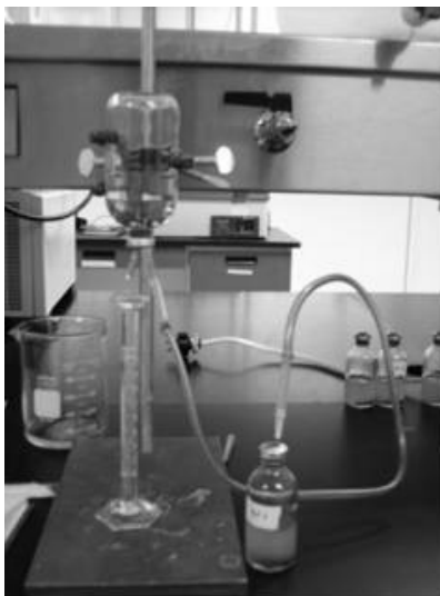
Figura 7.1. Método de desplazamiento de volumen. El metano producido se cuantifica por desplazamiento de volumen en la trampa de NaOH
