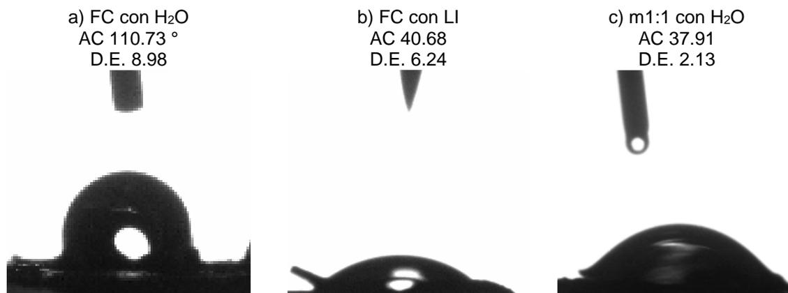
Figura 19. Ángulo de contacto de a) Fibra carbonizada con agua, se observa mayor hidrofobicidad del material; b) Fibra carbonizada con líquido iónico, se observa afinidad por el líquido iónico; c) Fibra carbonizada impregnada con líquido iónico probada con H<sub>2</sub>O, donde se observa que la hidrofobicidad es menor en comparación a la fibra carbonizada.
