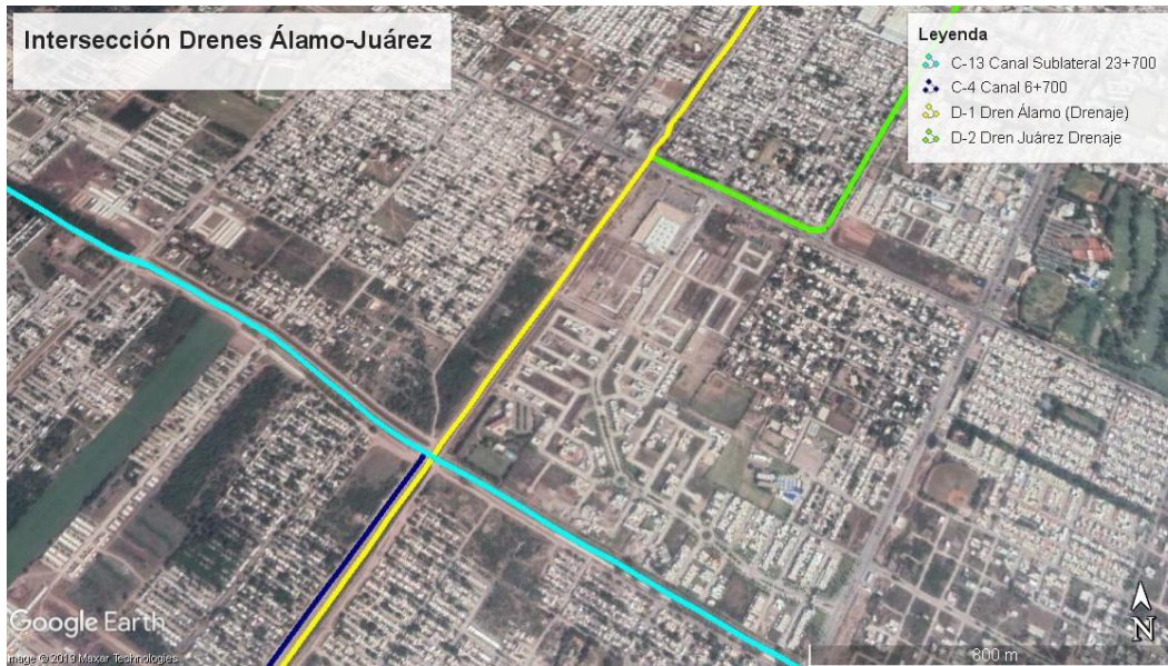
Figura 14. Intersección entre el Dren Álamo (23) y el Dren Juárez (24). El área comprendida entre esta confluencia y el Canal Sublateral 23+700 (13) y sus alrededores, es un punto crítico, ya que, en época de lluvias suelen presentarse inundaciones por el desborde de estas infraestructuras hidráulicas.
