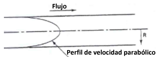
Figura 3 Condiciones REV para flujo laminar estable.
