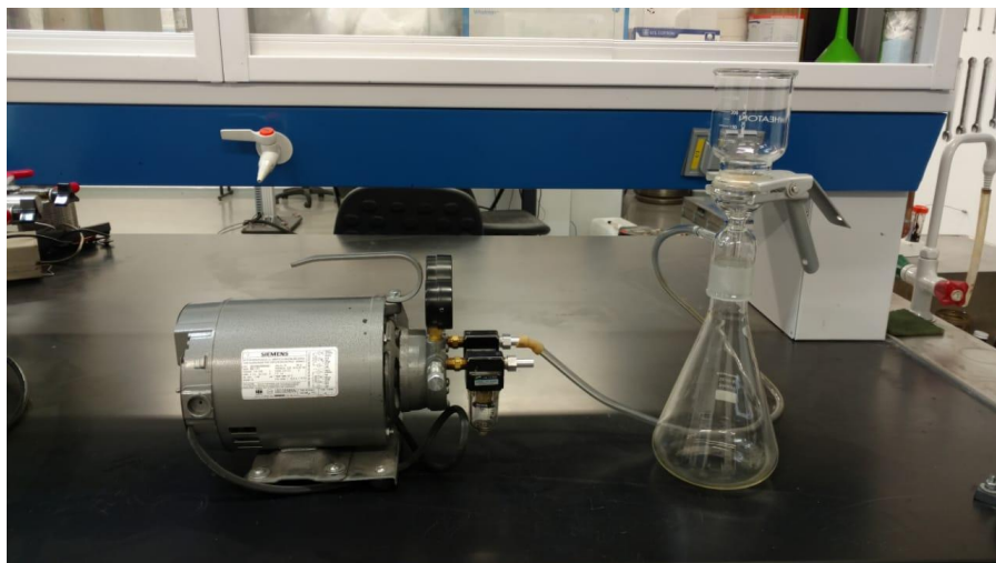
Figura 17 Montaje para separar asfaltenos por Método SARA.
