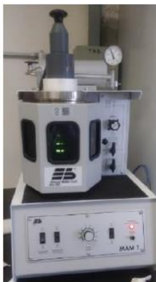
Figura 6. Horno de arco eléctrico.
