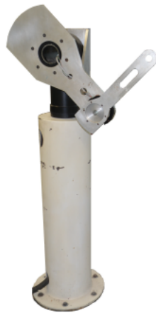
Figure 1.2: 3-DOF robot manipulator at Benemérita Universidad Autónoma de Puebla .
