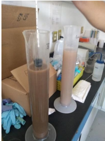
Figura 57. Midiendo la concentración de las partículas suspendidas con el hidrómetro..
