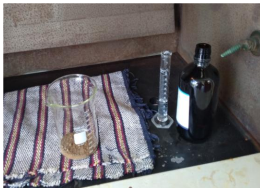
Figura 52. Eliminación de la materia orgánica mediante la aplicación de peróxido de hidrogeno.
