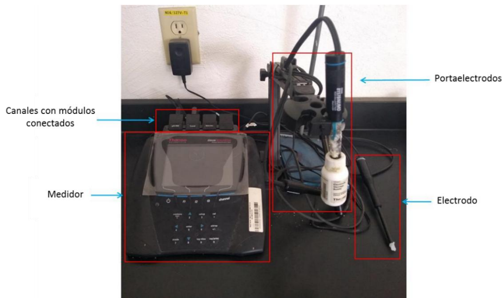
Figura 48. Partes del multiparametro Orion Versa Star Pro Electrochemistry Meters.
