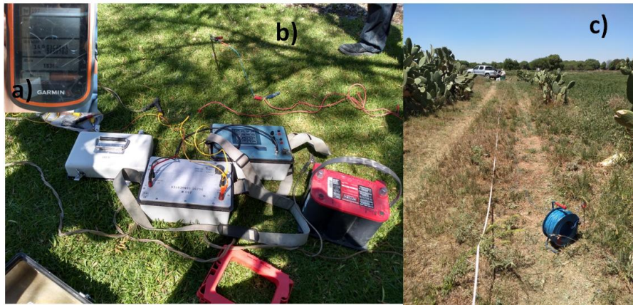
Figura 40. Equipo utilizado para la adquisición de datos geoelectricos, a) GPS de mano Garmin marca eTrex 20, b) Resistivímetro, convertidor de corriente, fuente de inyección externa (batería) y cables conectores, c) Carrete, electrodo y cinta de métrica.
