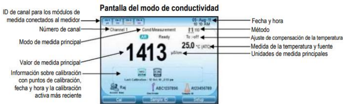
Figura 49. Pantalla del mutiparámetros con una medida de conductividad. Fuente: Thermo Scientific, 2015.
