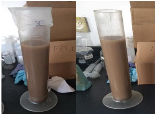
Figura 56. Muestra en probeta tapada para agitarlo manualmente.
