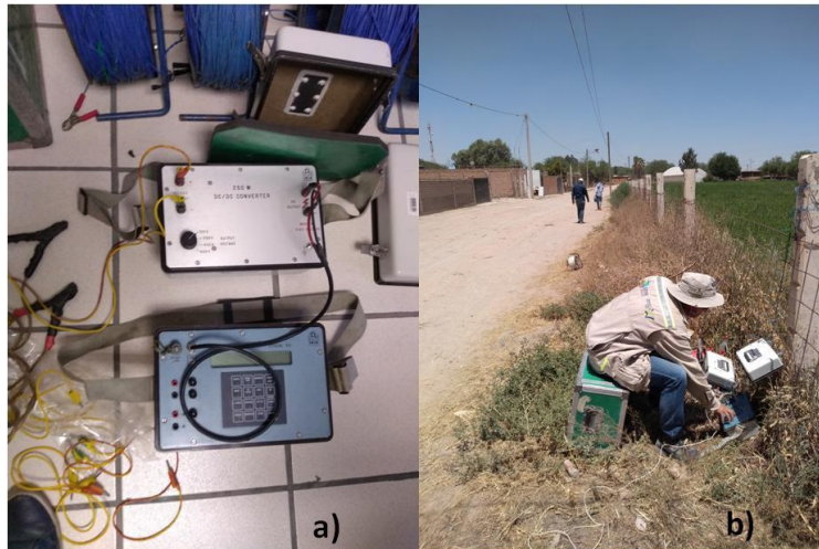
Figura 43. a) Resistivímetro Syskal-R2 de Iris instruments, b) Adquisición de datos de resistividad aparente del perfil AA'.
