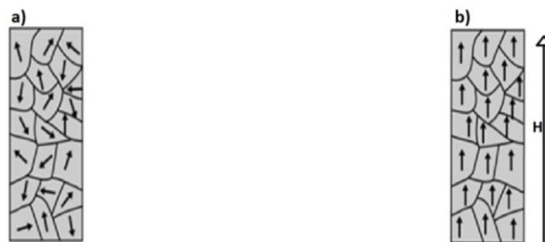
Figura 6. Dominios magnéticos orientados de forma aleatoria delimitados por una pared de dominio denotada con líneas color negro a). Dominios magnéticos orientados por la acción de un campo H aplicado.
