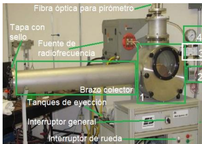
Figura 2.3. Sistema de temple rotatorio modelo SC de la firma Edmund Bühler utilizado para síntesis por solidificación rápida de las aleaciones TbFeSi y DyFeSi. En la foto se señalan sus principales componentes: 1. cámara principal; 2. display de información del equipo; 3. control de válvulas de cámara principal, portacrisol y tanques de eyección; 4. manómetro de tanques de eyección.
