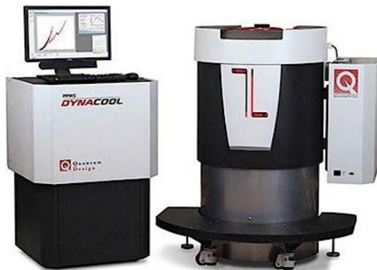
Figura 2.8. Sistema de medición de propiedades físicas PPMS de la marca Quantum Design, modelo Dynacool 9 T, utilizado para las mediciones de magnetización [20].
