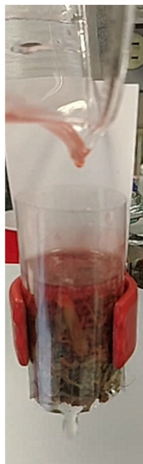
Figura 5.18: Filtro de lirio recubierto separando aceite de agua.
