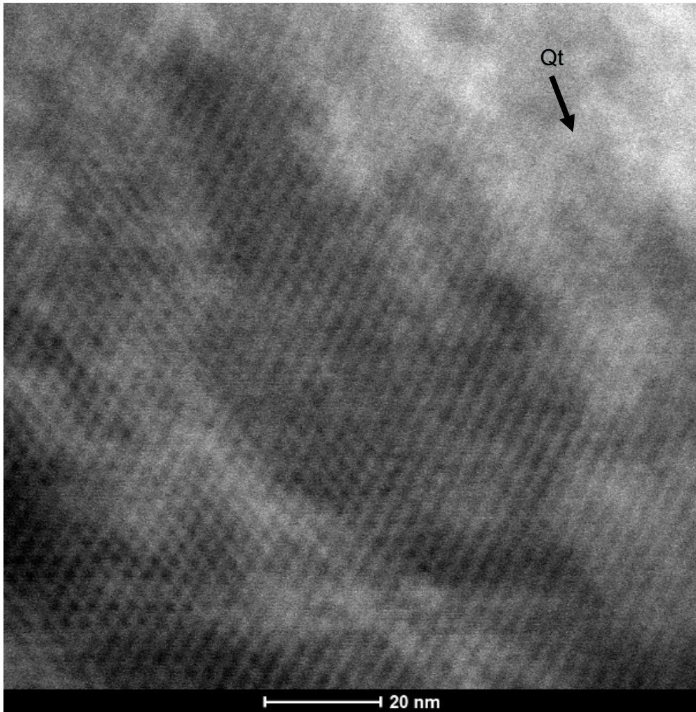
Figura 48. Micrografía representativa del CM obtenida por MET con un detector DAACO. En ella se muestra la mesoporosidad de las \text{PmSiO}_2 cubiertas de una capa de Qt.
