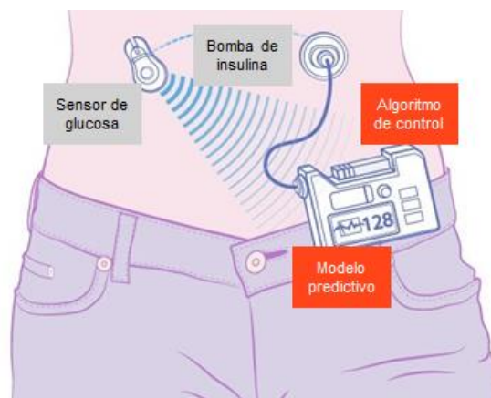
Figura 1.2 Componentes del Páncreas Artificial. A través de un transmisor en el sensor de glucosa es posible intercambiar información con un dispositivo receptor encargado de determinar la tasa continua de insulina que debe ser suministrada al paciente.
