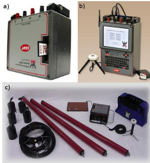
Figura 48. Imagen ilustrativa de los equipos utilizados en campo para la adquisición de los sondeos Magnetotelúricos. a) MTU-5A, b) V8 y c) componentes adicionales del equipo.
