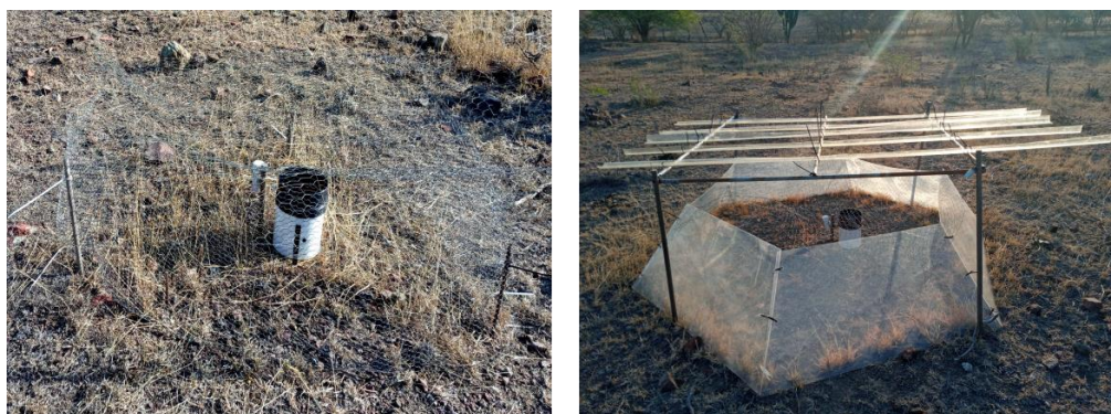
Figura 1.1. Parcela control cercada con malla de alambre (panel izquierdo) y parcela de SCC con cámara de techo abierto para aumentar la temperatura y refugio contra la lluvia para reducir la lluvia (panel derecho). Los dispositivos dentro de las unidades experimentales son los sensores de temperatura y lluvia.
