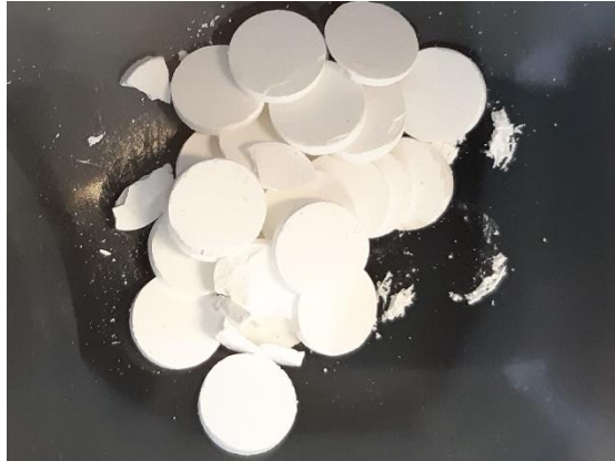
Figura. 6.1 Pellets formados por \text{CaCO}_3 en polvo y aglomerados con \text{Ca}(\text{OH})_2 .
