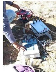
Fig. 38. Mediciones eléctricas con equipo Syscal R2.
