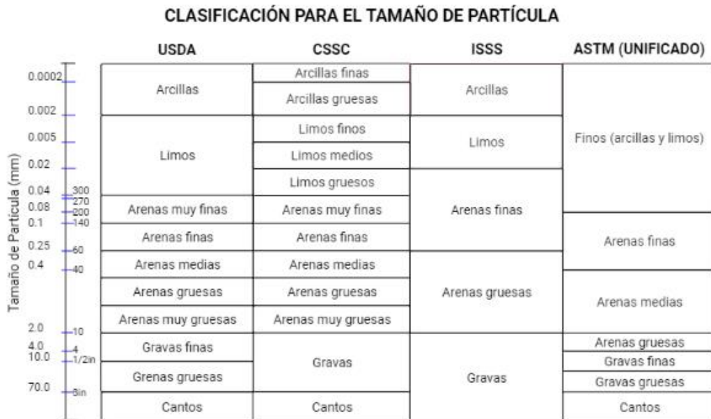
Figura 2-2. Límites de tamaño de partículas según los sistemas de clasificación más usados. Tomado y adaptado de (Ruby and Lowney, 2012) y elaborado por la autora en BioRender.com.
