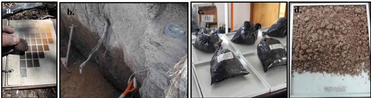
Figura 2-1. Registro fotográfico de observaciones en campo y prácticas en laboratorio. a) Identificación del color en húmedo por comparación con la guía de color de Munsell (USDA, 2013); como parte de la descripción in situ del perfil suelo. b) Medición de densidad aparente. c) Muestras de suelo preparadas para análisis. d) Muestra de suelo aireada y dispuesta para ser procesada. Archivo de la autora.
