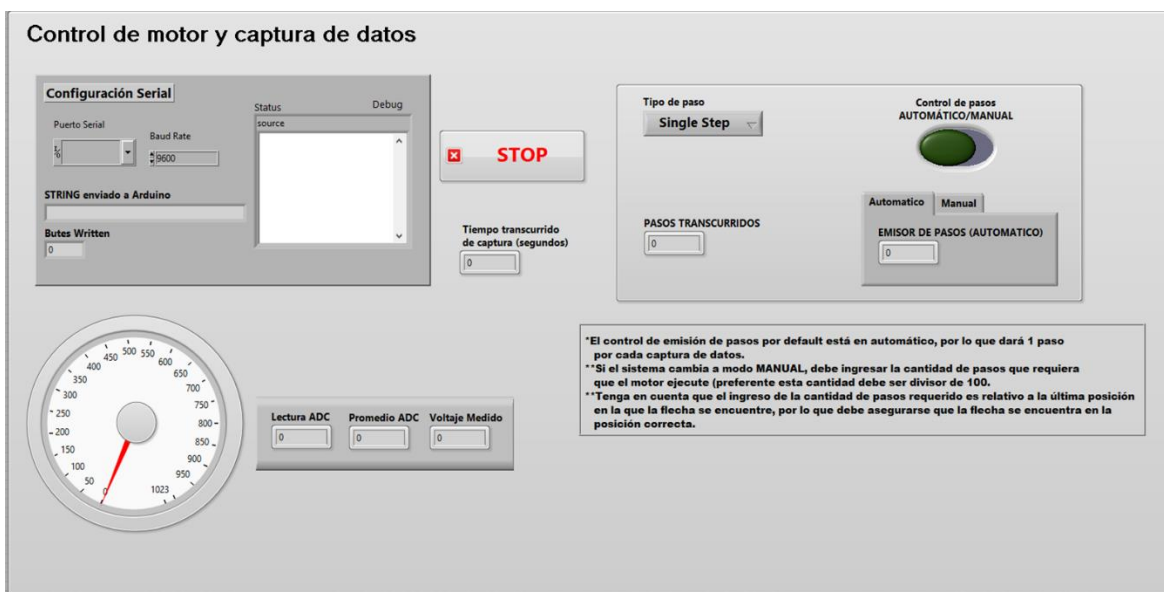
Figura A6. Interfaz del programa para la rotación del motor NEMA-17.
