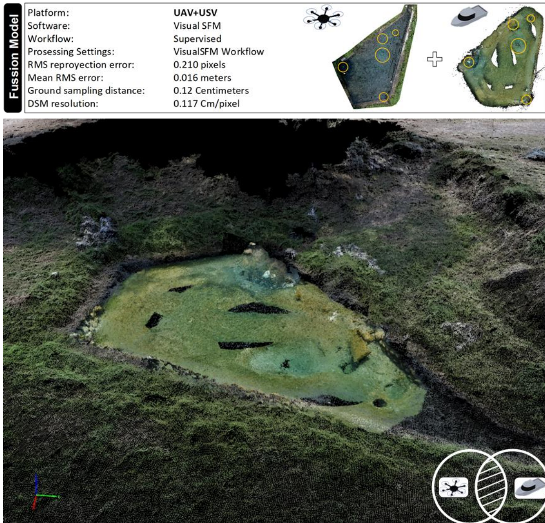
Figura 31. Reconstrucción obtenida a partir de la fusión de las técnicas SFM y fotogrametría digital aérea de cada una de las plataformas UAV-USV.
