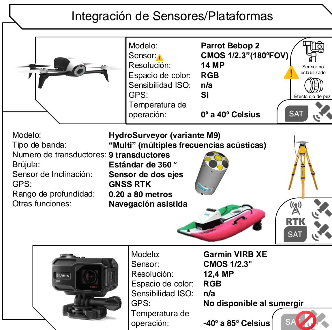
Figura 33. esquema de integración de plataformas y sensores para el caso de estudio.
