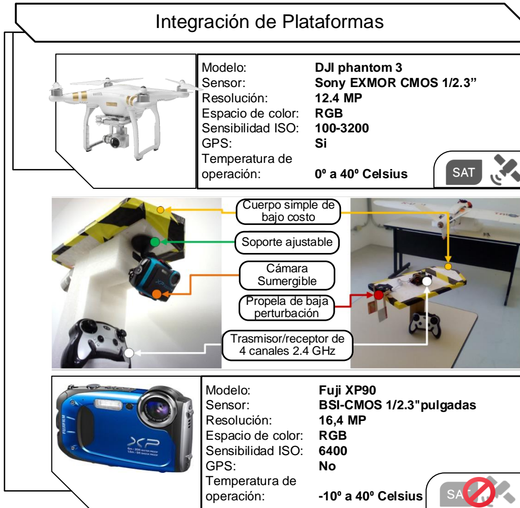
Figura 24. La primera fila muestra las características principales del sensor aerotransportado, en la parte central se muestra un diagrama simplificado de las características principales de la plataforma remota y el acople del sensor sumergible, finalmente el modelo y características del sensor integrado en el UAV se muestran en la última fila del diagrama.
