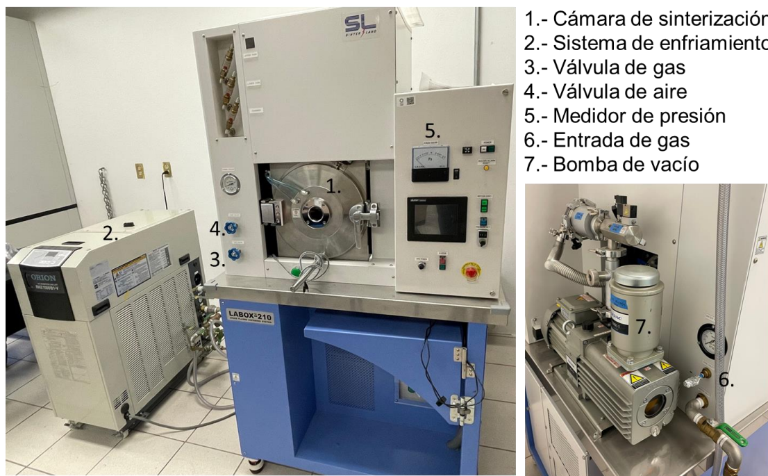
Figura 2.4. Equipo de sinterización por chispa y plasma Labox-210 de la firma japonesa Sinter Land Inc. empleado en el presente trabajo.
