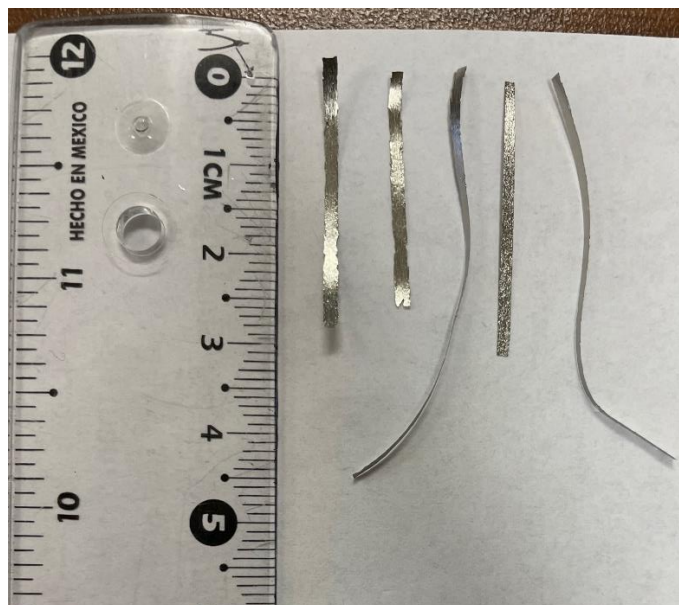
Figura 2.3. Dimensiones de las cintas obtenidas de DyNi 5 mediante la técnica de temple rotatorio para la serie M3.
