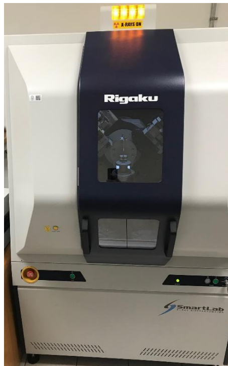
Figura 2.5. Difractómetro Rigaku SmartLab, radiación \text{CuK}\alpha_1 ( \lambda = 1.540598 Å).
