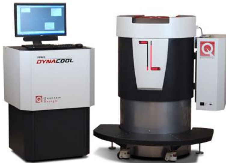
Figura 2.8. Equipo de medición de propiedades físicas (PPMS) modelo Dynacool de la firma Quantum Design Inc.
