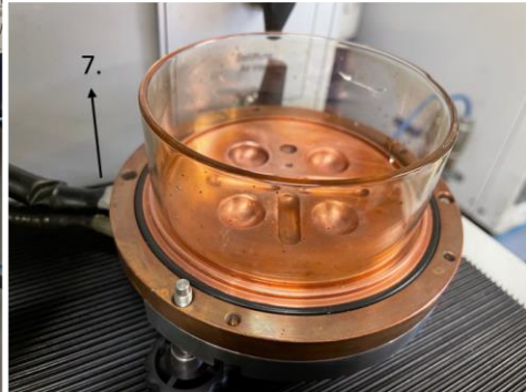
Figura 2.1. Foto y partes principales del horno de arco eléctrico modelo MAM-1 de la firma alemana Edmund Bülher GmbH utilizado para producir las aleaciones en bulto.
