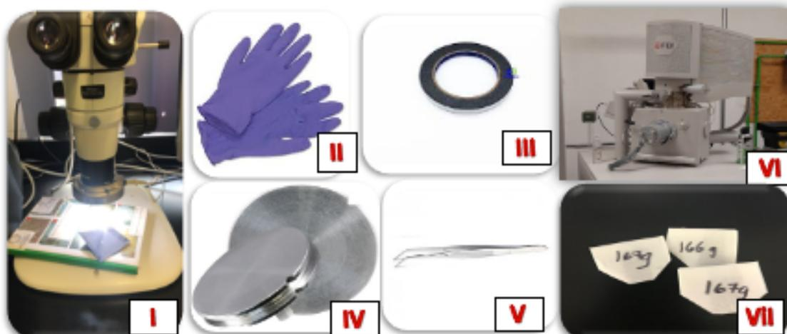
Figura 4.5 Materiales que se utilizaron para la preparación de la muestra NWB para después observarla en el MEB. I) Microscopio Nikon SMZ 1000 II) Guantes de nitrilo III) Cinta de carbono doble cara IV) Pin de metal V) Pinzas VI) MEB VII) Muestra NWB no tratada y tratada a 12h, 24h y 48h en ácidos fuertes.
