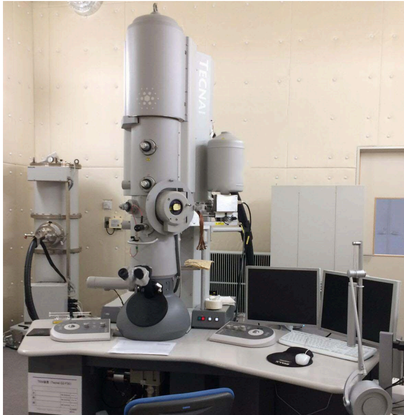
Figura A.4 Equipo TEM: HR-TEM FEI Tecnai F30 (300 keV).
