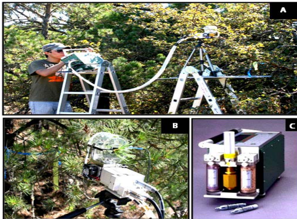
Figura 6. Equipo de medición de intercambio de gases. A) Sistema portátil de fotosíntesis; B) cámara de coníferas y C) dosificador de la concentración de CO 2 .
